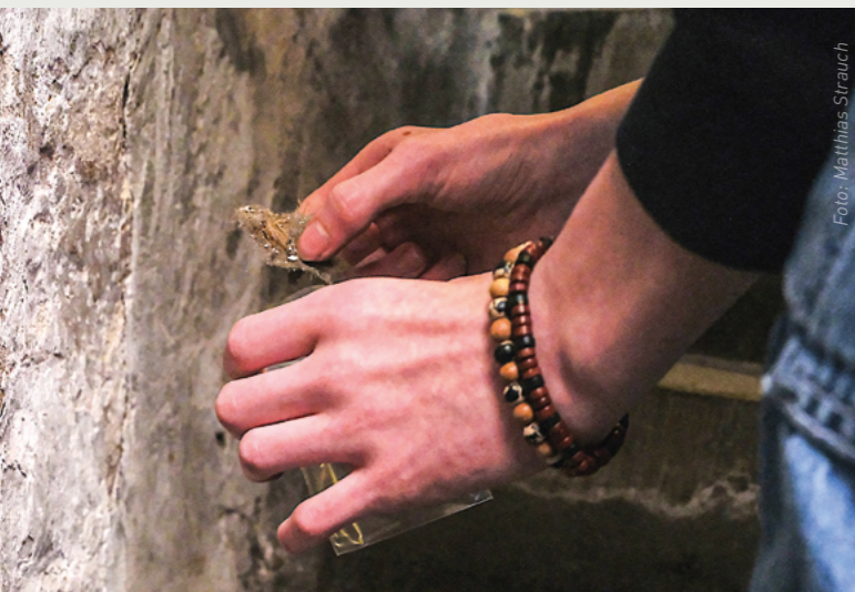
Staubentnahme auf der Wendeltreppe im Alten Rathaus
